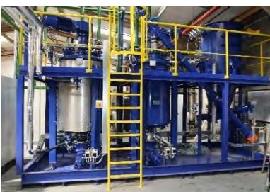
Estaciones de mezclado para combinar polioles con cargas sólidas
