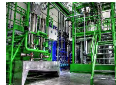
Reactores para el reciclaje químico de residuos de espuma de PU rígida y flexible (recuperación de polioli)
