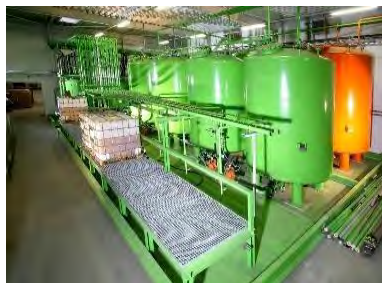
Sistemas de almacenamiento en tanques para polioli, isocianato y pentano
