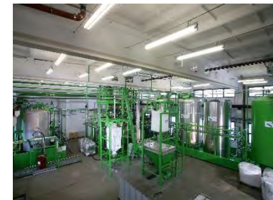
Reactores para la generación de polioli poliéster a base de PET, anhídrido ftálico y aceites naturales
