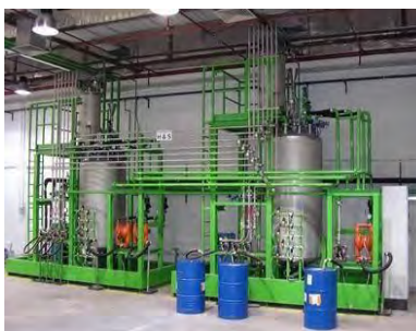
Estaciones de mezclado para combinar polioles con aditivos líquidos y mezcla en línea de polioli con agentes espumantes
